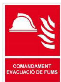
Imagen 1. Señalización del cuadro de control del SCTEH
