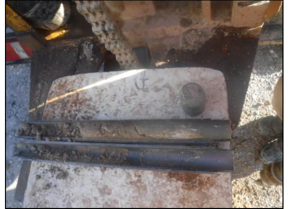
Foto 26: Sondeig S-10, SPT a 5,6 metres.
