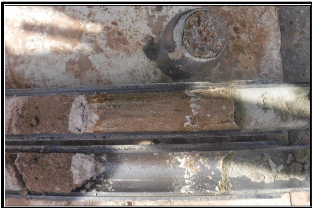
Materials de la capa B, recuperats a un assaig SPT.
