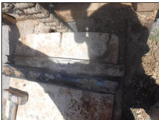
Foto 23: Sondeig S-9, SPT a 5,8 metres.
