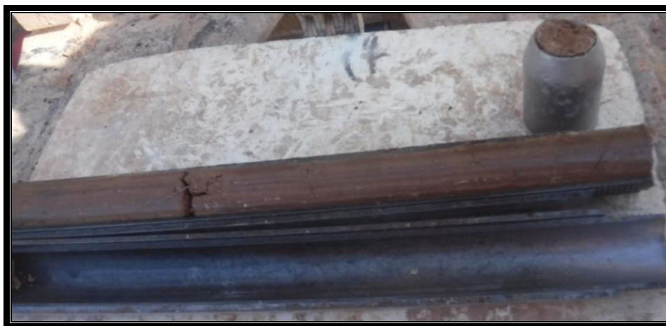
Materials de la capa A, recuperats a un assaig SPT.
