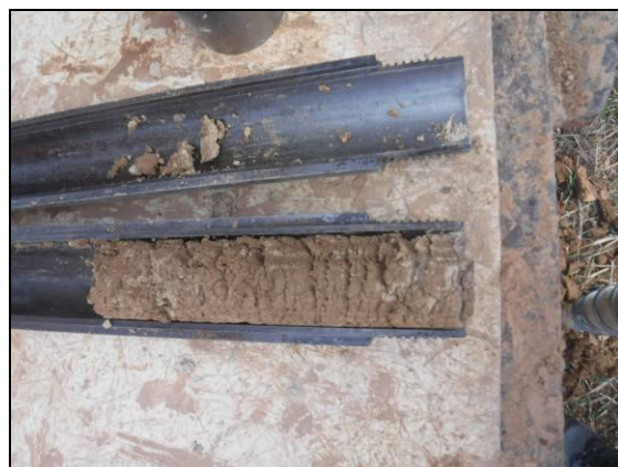
Foto 4: Sondeig S-1, SPT a 8,5 metres.
