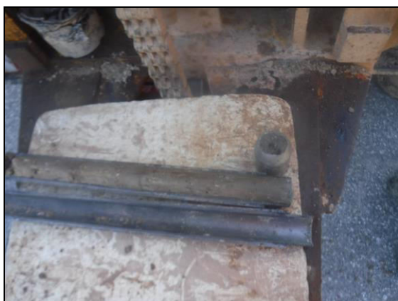
Foto 15: Sondeig S-6, SPT a 2,9 metres.
