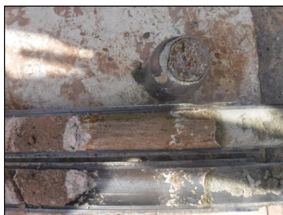
Foto 6: Sondeig S-2, SPT a 1,3 metres.
