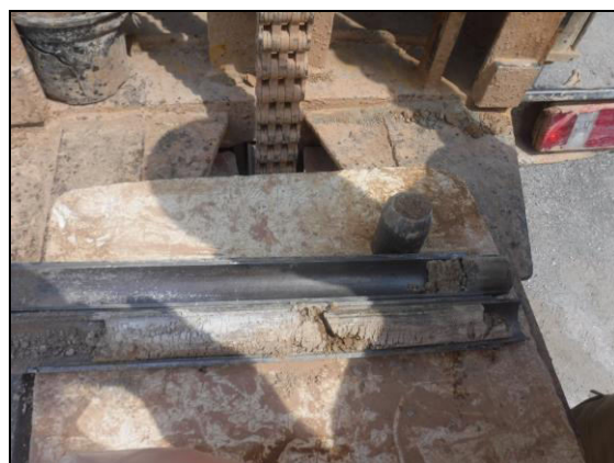
Foto 8: Sondeig S-3, SPT a 1,0 metre.
