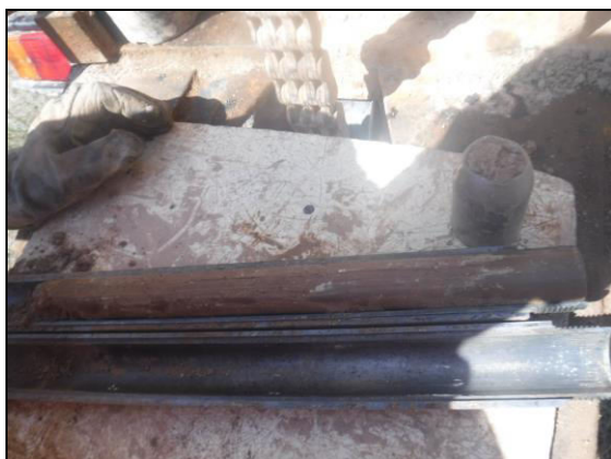
Foto 19: Sondeig S-8, SPT a 1,2 metres.
