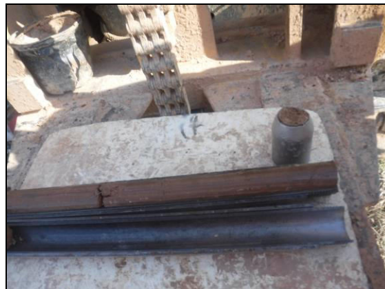
Foto 2: Sondeig S-1, SPT a 1,4 metres.
