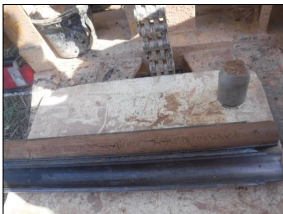
Foto 3: Sondeig S-1, SPT a 4,6 metres.
