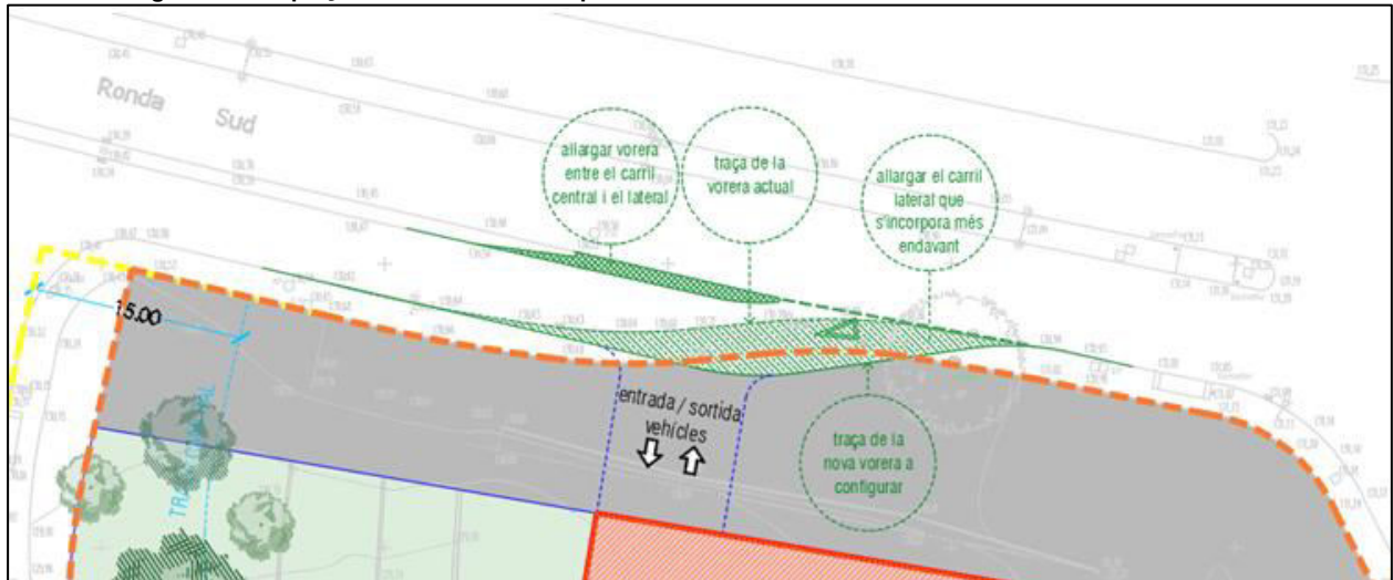
Figura 48. Desplaçament del vial d'incorporació del lateral al tronc central de la Carretera Ronda Sud
